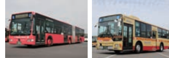
大量輸送ニーズがある路線への連節バス導入 ノンステップバスの積極的な導入
