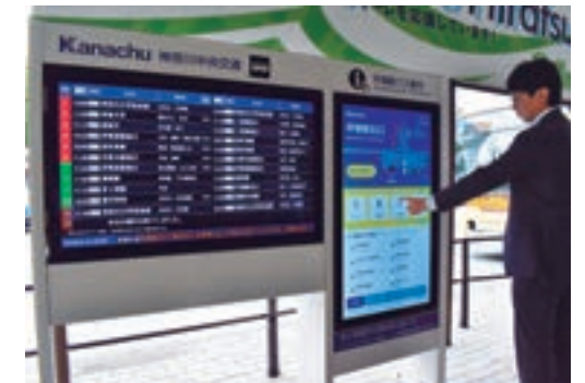
タッチ式デジタルサイネージ(多言語による目的地検索システム)およびバス運行情報案内表示機
