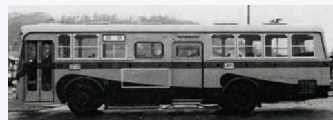
ホイールベース間に取り付けた巻き込み防止装置
