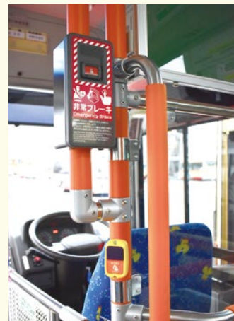
非常ブレーキスイッチが設置されたEDSS搭載バス
