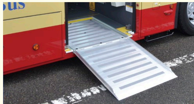
緩やかな設置角度となった反転式スロープ
