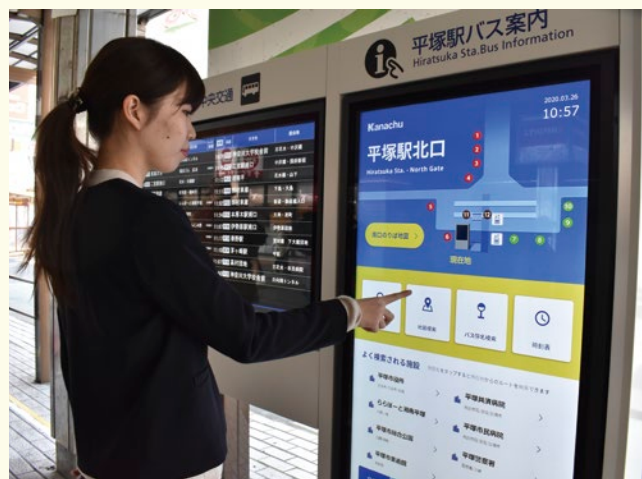
タッチ式デジタルサイネージの 目的地検索システム（右画面）と、バス運行情報案内表示機（左画面）
