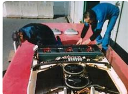
(3) 豊橋にある車庫での様子。 冷暖房など、ドイツでは備え付け られなかった装備が、ここで取り 付けられます
